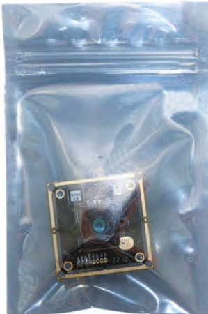
Sigillare il vassoio con un sacchetto antistatico
